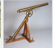
Paratatisch montierter Refraktor. Hersteller: Johann Friedrich Schmeisser, Meiningen & Hild, Ende 18. Jhd., Fotograf: Lutz Ehlhardt
